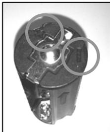
電池ホルダーの両脇には、電池の極性を表す「+」「-」(丸印部分)が記述されていますので、マークの指示のとおり電池をセットしてください。
